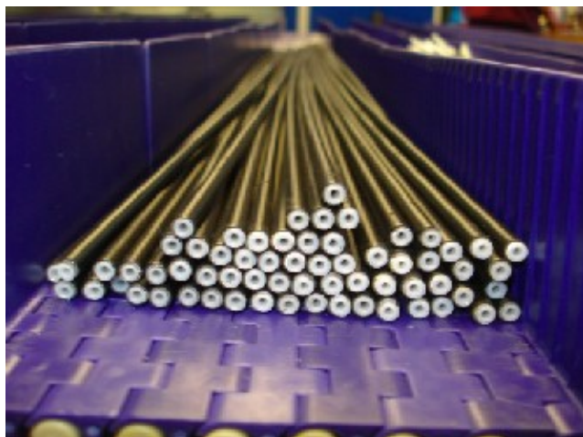
Einschieben von POM Rohr mit Auftulpen (Trompete)
