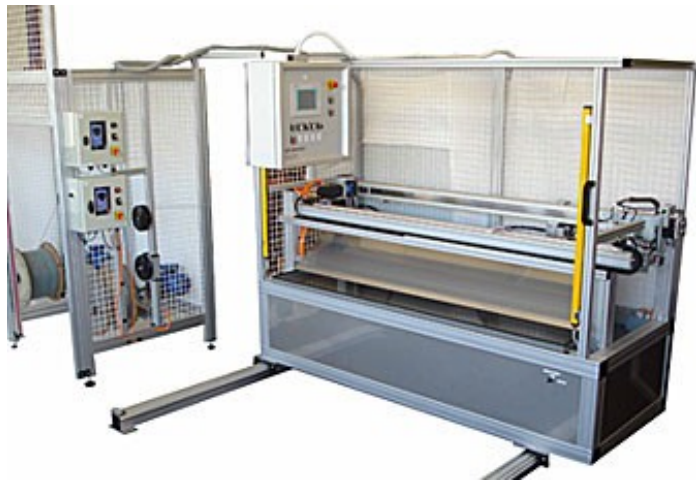
Drahtseilzuführung AT 2000 zu Fishertech Spritzgussmaschine seitlich verschiebbar
